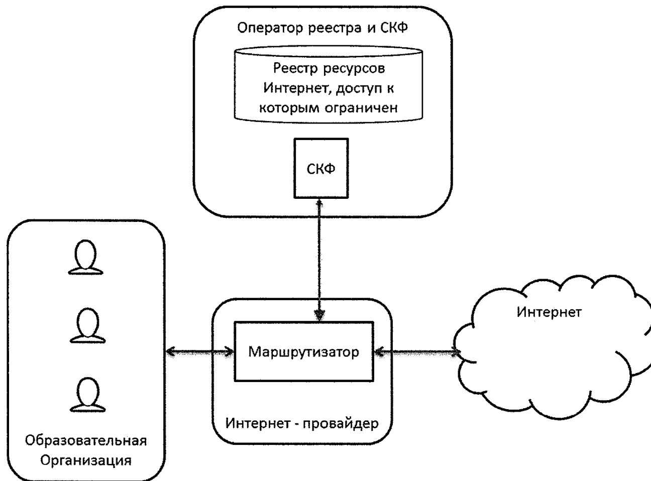
Рисунок 5. Схема работы контент-фильтрации при едином решении
